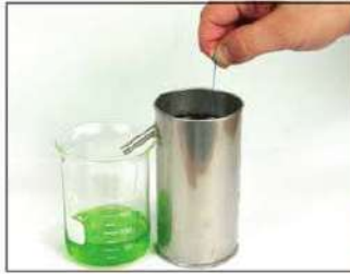
شكل (١٠): قياس الكثافة باستخدام الميزان والمخبار المدرج ينتج عنه خطاين في القياس.
